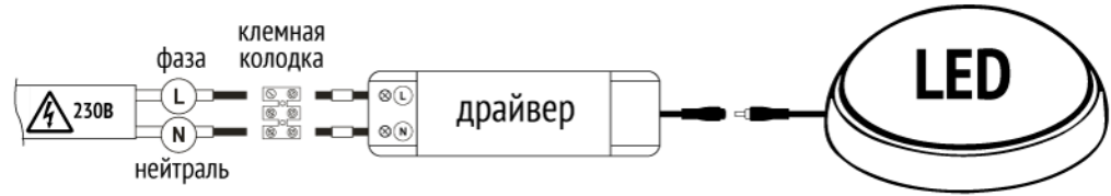
Рис.1. Схема подключения светодиодного светильника к эклектической сети 230В.
